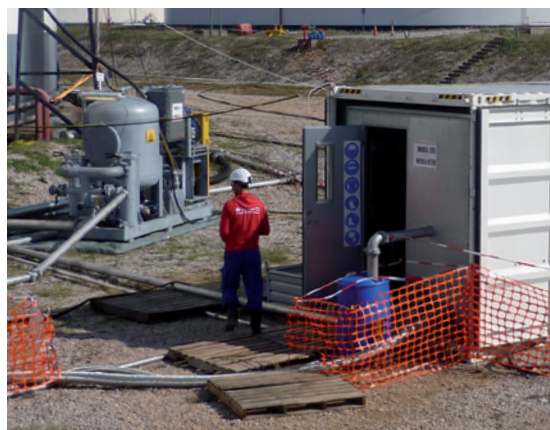
Les jet washers sont entièrement automatisées et sont contrôlées via un panneau tactile situé dans les conteneurs
